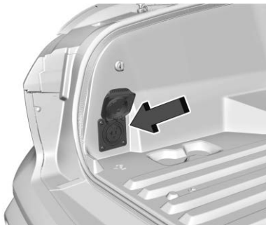
eTrunk™ 12 Volt Power Outlet
