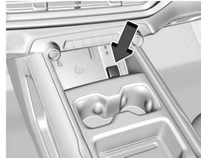
Center Console 12 Volt Power Outlet
